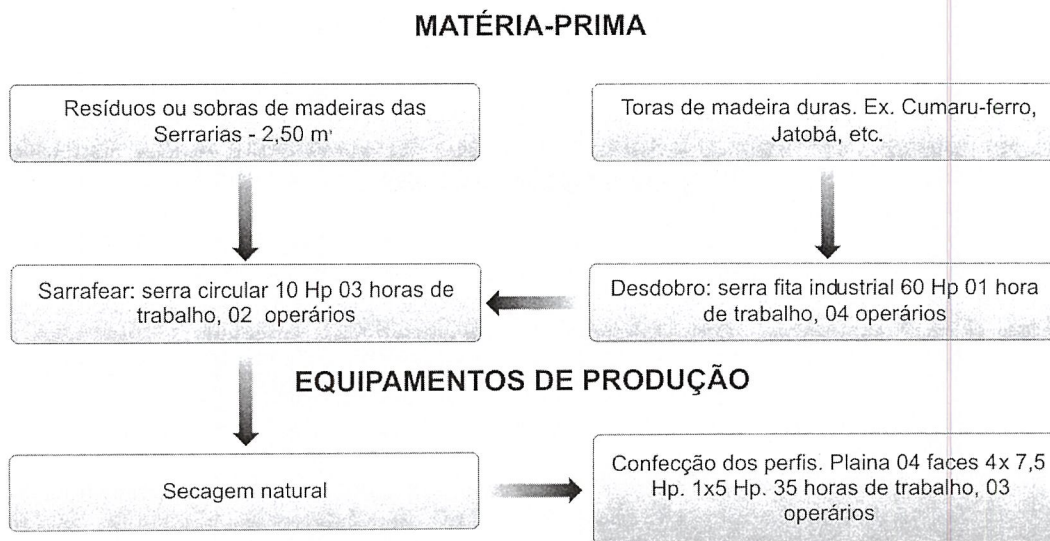
Figura 5. Produção de perfis, assoalho e fechamento lateral.
