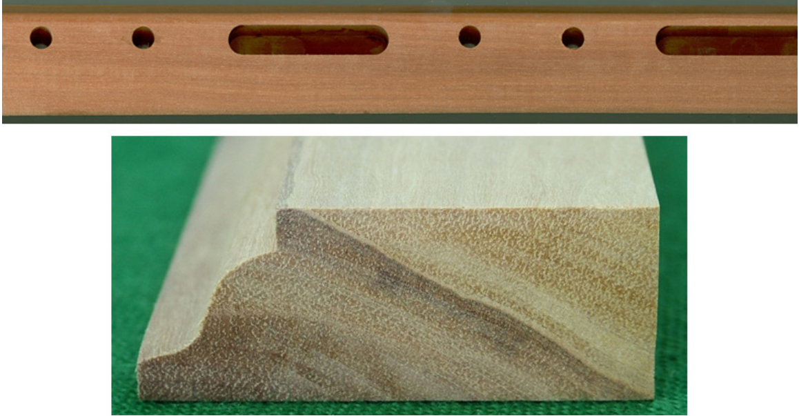
Figura 3.9.10 Imágenes de la trabajabilidad de la madera de Chicozapote.
