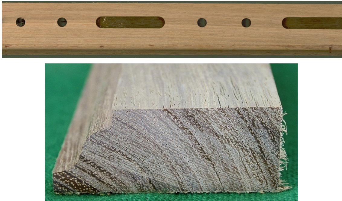
Figura 3.9.18 Imágenes de la trabajabilidad de la madera de Tzalam.
