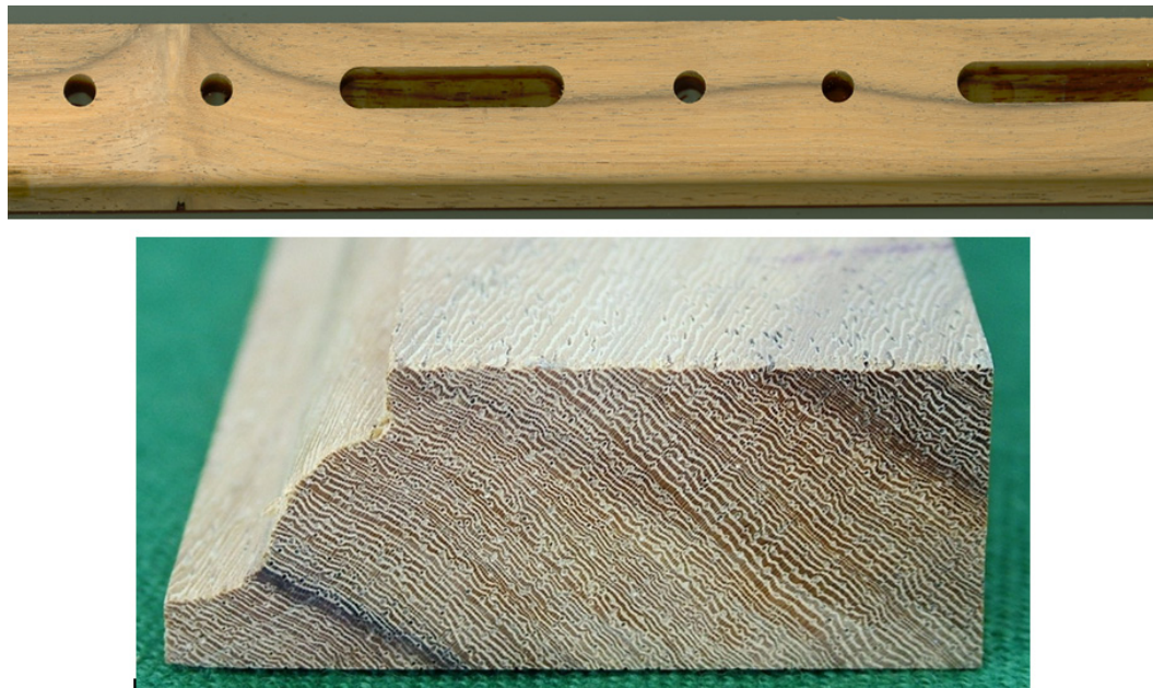
Figura 3.9.12 Imágenes de trabajabilidad de la madera de Jabón.
