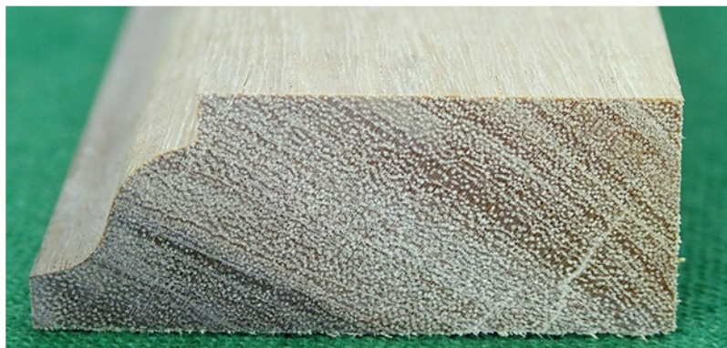
Figura 3.9.15 Imágenes de trabajabilidad de la madera de Pukté.
