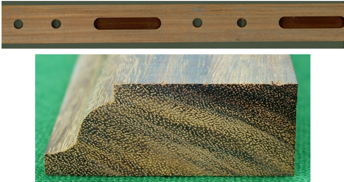
Figura 3.9.11 Imágenes de la trabajabilidad de la madera de Granadillo.
