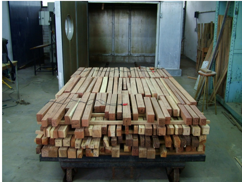
Figura 3.8.4 Listones de madera antes del acondicionamiento en el secador convencional.
