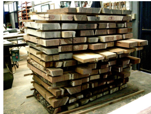
Figura 3.3.3 Seccionamiento de los tabloncillos obtenidos del aserrío de las trozas.
