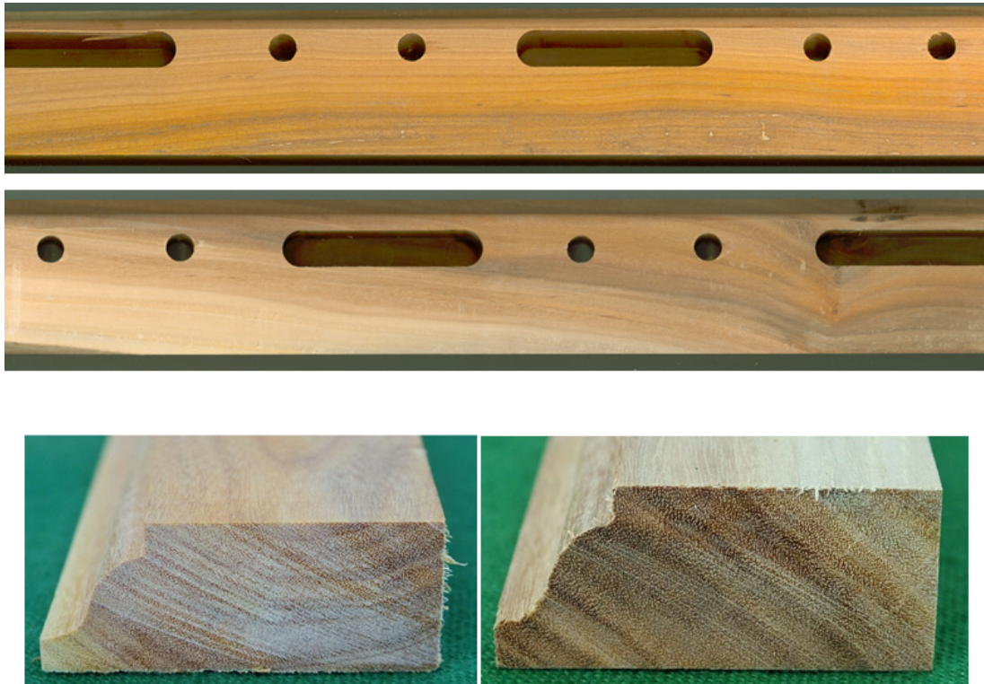
Figura 3.9.8 Imágenes de la trabajabilidad de la madera de Chakté-viga. Imagen superior Chakté-viga color naranjo, inferior de color café claro rosado.
