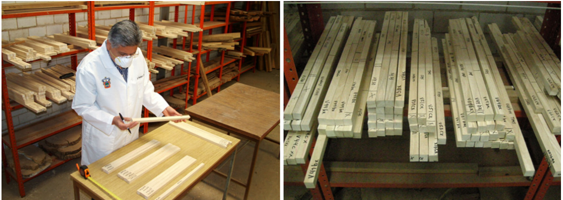
Figura 3.3.7. Selección de listones para la elaboración de probetas de ensayos mecánicos.
