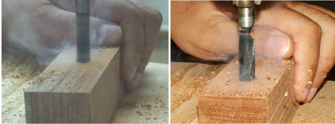
Figura 3.9.4. Quemado de la madera al barrenar a altas revoluciones.
